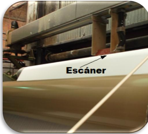
Fig. 25.- Escáner de monitoreo y registro de la humedad en el papel.
