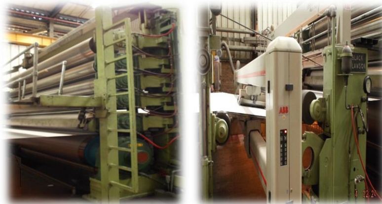
Figura 13.- Rodillos de calandra y escáner ABB.
