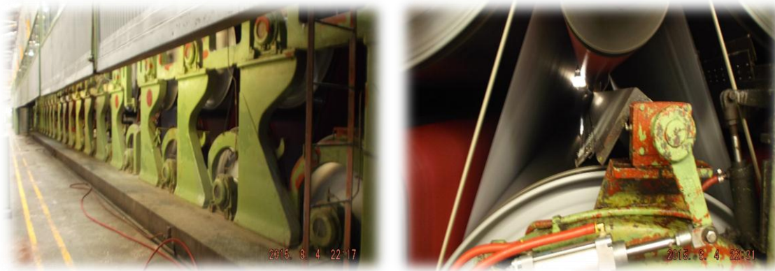
Figura 11.- Secciones de secado.
