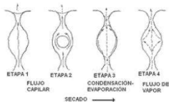
Figura 17.- Etapas del movimiento de humedad durante el secado de un medio poroso.
