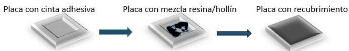
Figura 4.4. Preparación de muestras resina-hollín.
