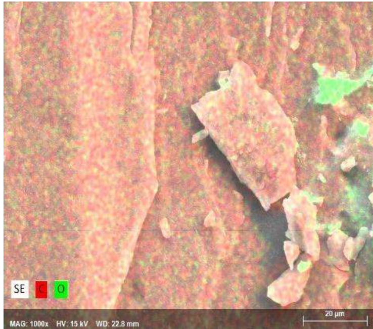
Figura 5.23. Distribución de carbón y oxígeno en la muestra con 10% hollín.
