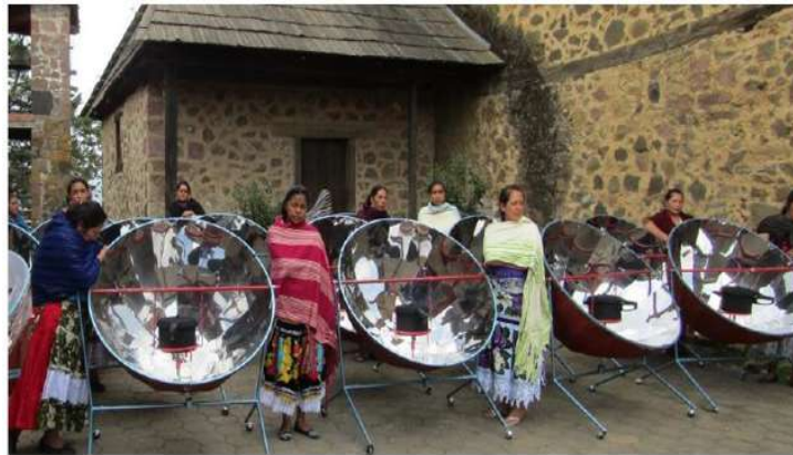
Figura 2.19. Estufas solares con recubrimiento de hollín [26].
