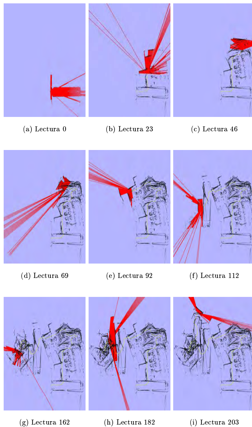
Figura 5.5: Lecturas del telémetro láser y el mapa 2D correspondiente utilizando el método de mínimos cuadrados.
