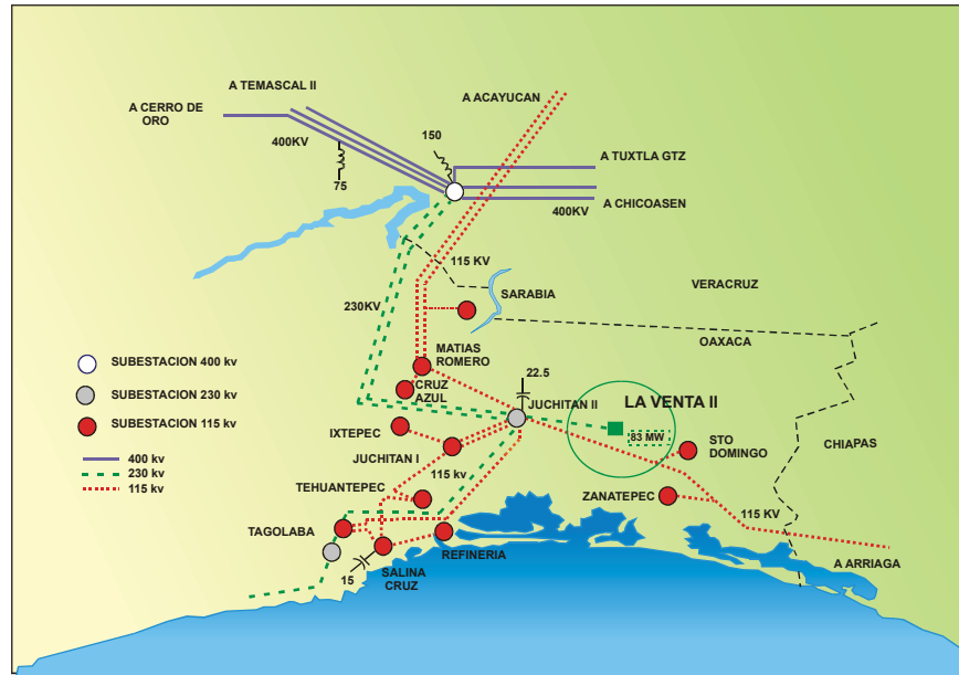
Figura 1.12 Conexión del Parque eólico de La Venta II al sistema eléctrico [CFE07].
