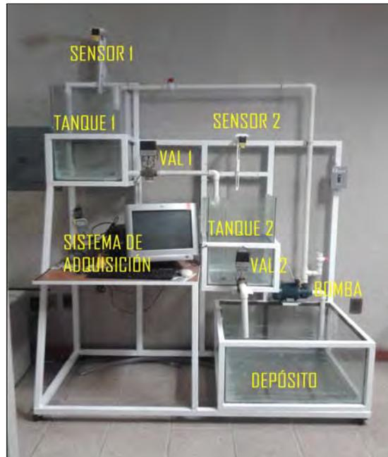
Figura 3.1: Sistema de Nivel de Líquido de dos tanques
