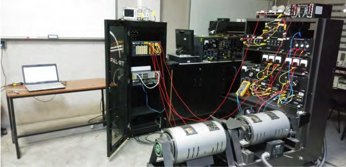
Figura 4.21: Red radial construida en laboratorio para pruebas de estimación en tiempo real.
