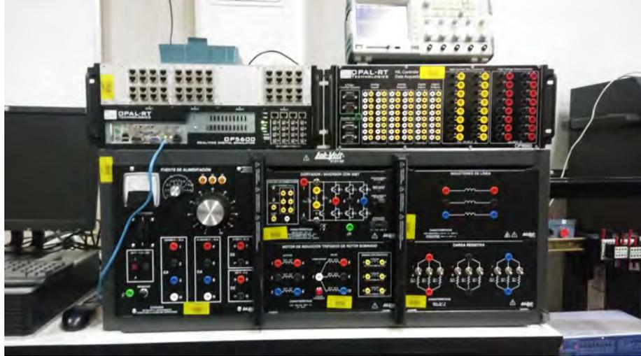
Figura A.1: Conjunto de simulador en tiempo real (OP5600) y modulo de control HIL y de adquisición de datos(OP8660)
