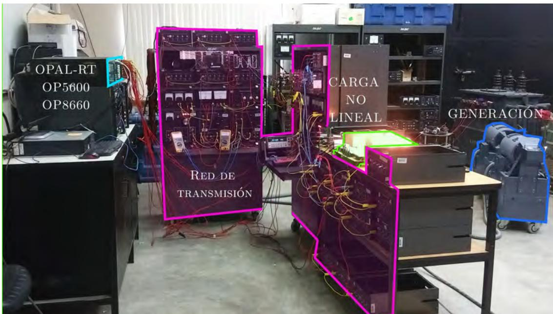
Figura 4.12: Red experimental de 5 nodos instrumentada con modulo OP8660
