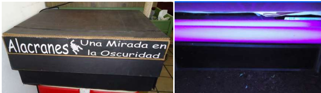
Figura 3. Caja negra para observación de cortejos y/o apareamientos en laboratorio.
