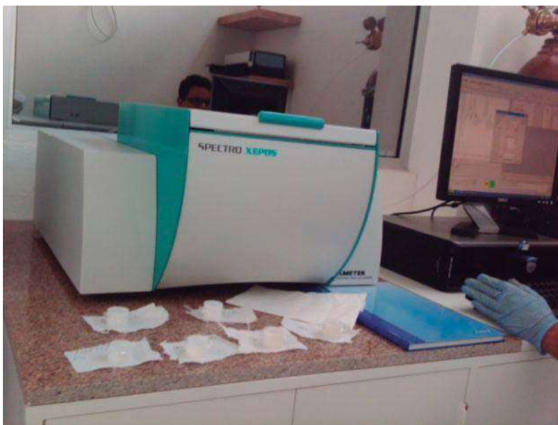
Figura 10. Espectrómetro de fluorescencia polarizada de rayos X de energía dispersiva (EPDXRF) (SpectroXepos-III, Spectro Analytical Instruments GmbH, Kleve, Alemania).
