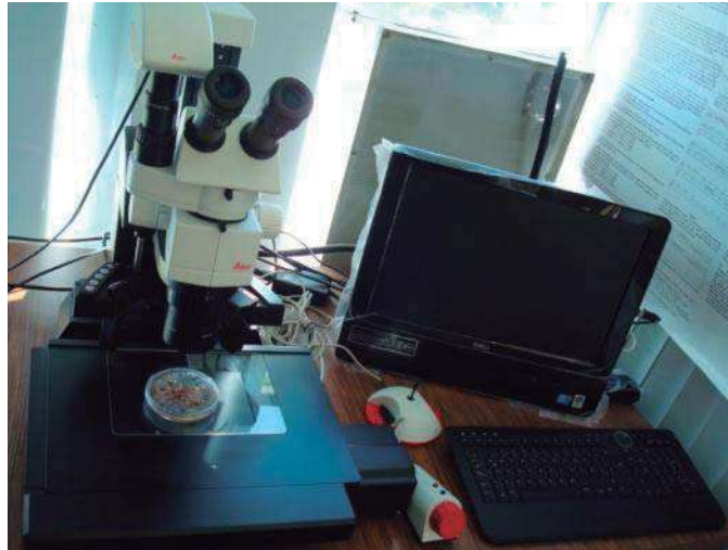
Figura 9. Microscopio estereoscópico marca Leica M80, acoplado a cámara, con Leica Application Suite V3.
