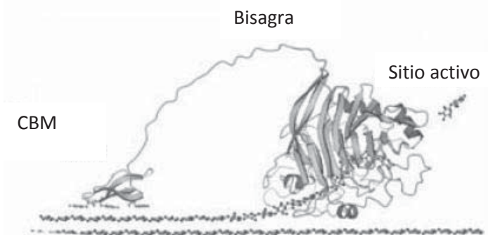
Figura 4. Modelo tridimensional de una celobiohidrolasa actuando sobre una cadena de celulosa. Se muestra el módulo catalítico en forma de túnel (liberando una molécula de celobiosa), la bisagra flexible y el CBM unido a la cadena de celulosa (Martínez y col., 2008).
