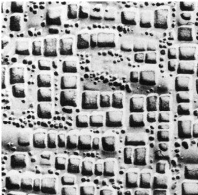
Figura 2.4. Microestructura de Nimonic 80 totalmente tratado térmicamente, que muestra un borde de grano de carburo M_{23}C_6 y cuboidal \gamma' uniformemente disperso en U-700 totalmente tratado térmicamente [27].
