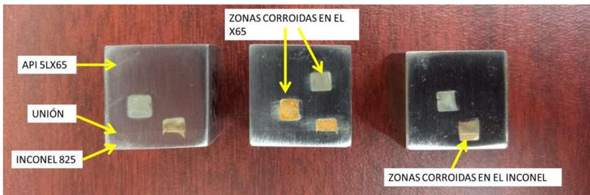
Figura 3.13. Piezas de la tubería bimetalica API 5LX65-INCONEL 825 sometidas a ensayos de corrosión.
