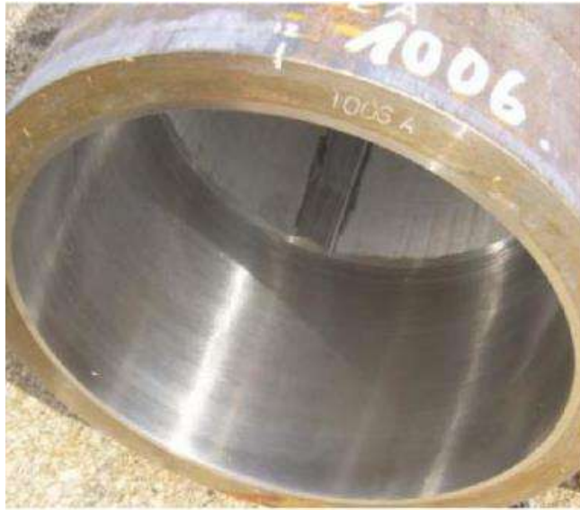
Figura 2.19. Muestra de la pieza de tubería revestida UNS N06625 [63].
