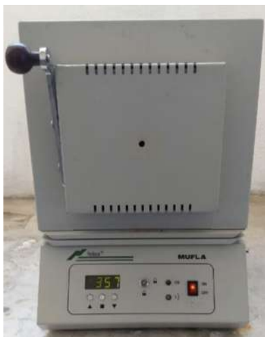
Figura 3.6. Horno o mufla utilizado para llevar a cabo los tratamientos térmicos.
