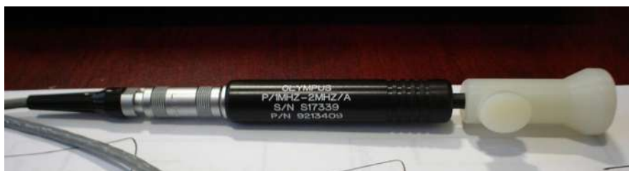
Figura 3.16. Sonda tipo lápiz para frecuencias 1-6MHz.
