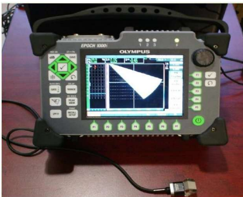
Figura 3.18. Equipo para inspección ultrasónica con Arreglo de Fases.
