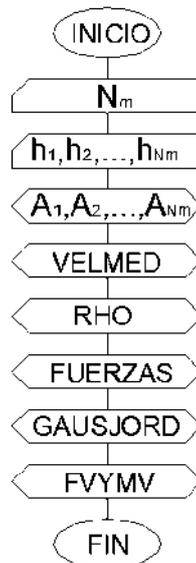
Figura A.1 Diagrama de flujo del programa Vestatico
