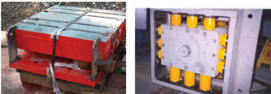
Figura 2-4. Aisladores del tipo multirrotacional (cortesía de [Hernández et al, 2005]).
