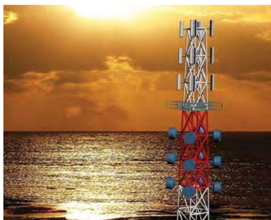
Figura 3.4.4 Antenas y plataforma de trabajo en las torres tipo 2
