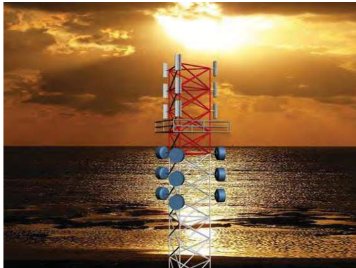
Figura 3.7.4 Antenas y plataforma de trabajo en las torres tipo 5
