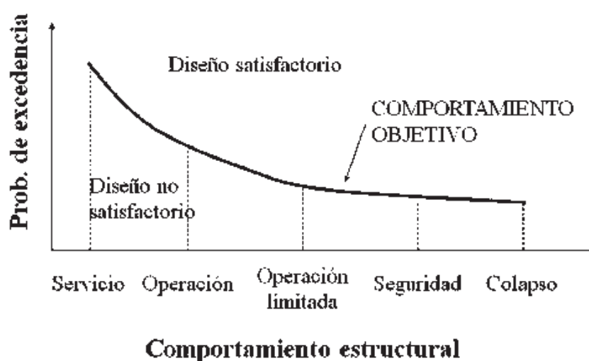
Figura 13.- Relación entre probabilidad de excedencia y respuesta estructural (Estados límite)
