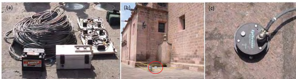
Figura 4.2 a) Equipo de medición. b) Ubicación de sensor triaxial. c) Sensor Triaxial.
