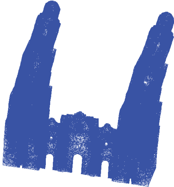
Figura 6.4 Tercer modo de vibrar de la estructura (desplazamiento paralelo al eje de la fachada).
