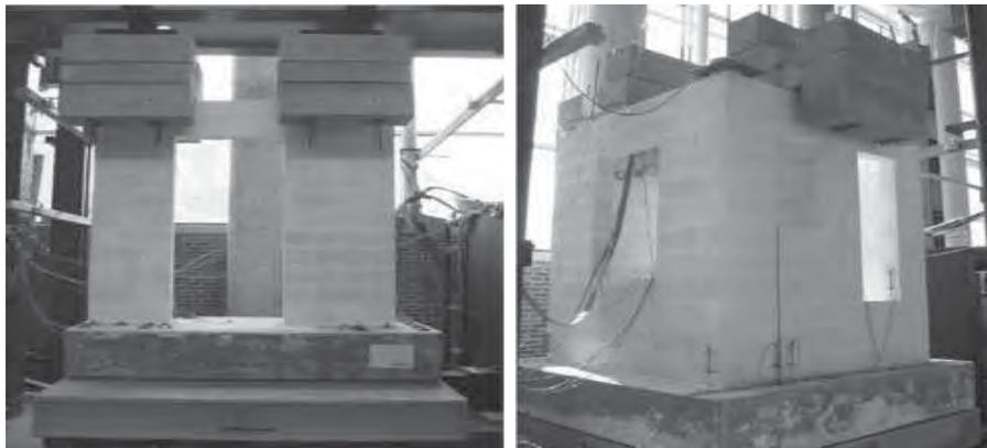
**Figura 1. 7 Especímenes de mampostería postensada con aberturas por puertas y ventanas**
