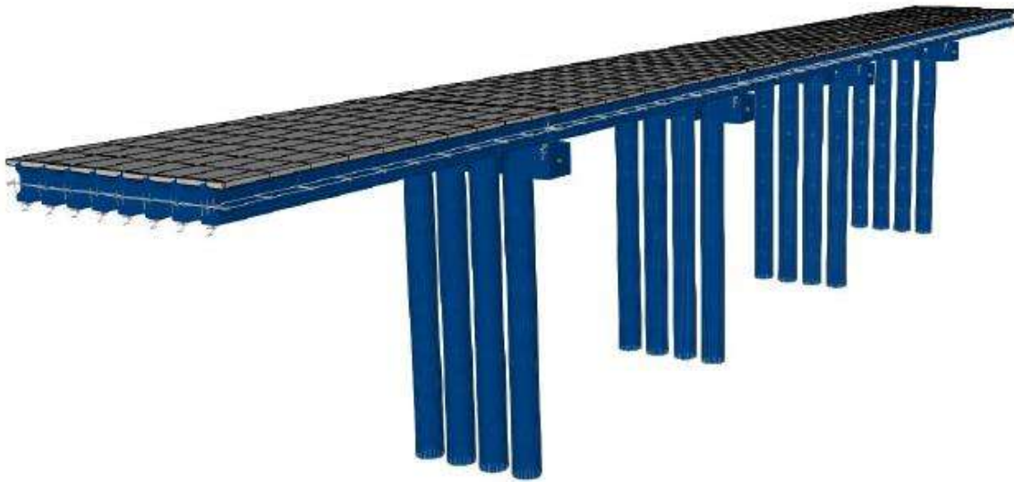
Figura 24. Modelo numérico del puente en SAP2000
