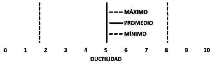
Figura 142. Demanda de ductilidad en aisladores del modelo TEH-02.
