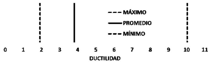
Figura 151. Demanda de ductilidad en aisladores del modelo XAL-02.
