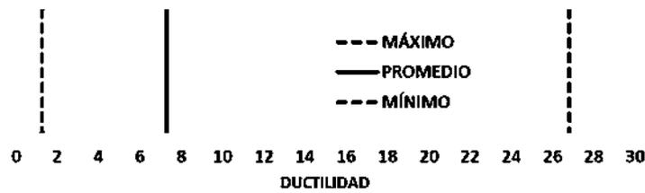
Figura 143. Demanda de ductilidad en aisladores del modelo PUE-10.
