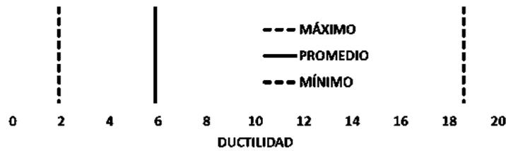
Figura 145. Demanda de ductilidad en aisladores del modelo PUE-02.
