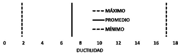
Figura 139. Demanda de ductilidad en aisladores del modelo HUA-02.
