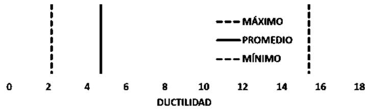
Figura 150. Demanda de ductilidad en aisladores del modelo XAL -05.
