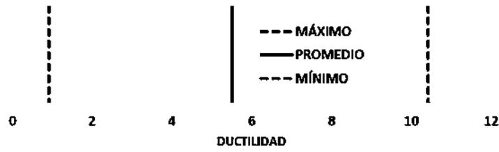
Figura 140. Demanda de ductilidad en aisladores del modelo TEH-10.
