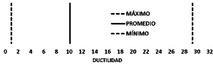
Figura 137. Demanda de ductilidad en aisladores del modelo HUA-10.
