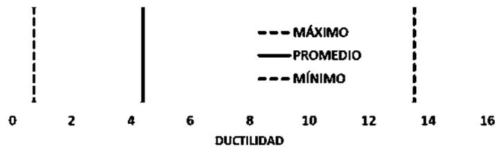
Figura 146. Demanda de ductilidad en aisladores del modelo COR-10.
