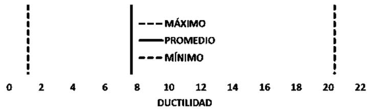
Figura 134. Demanda de ductilidad en aisladores del modelo OAX-10.
