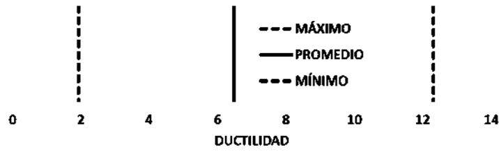
Figura 148. Demanda de ductilidad en aisladores del modelo COR-02.
