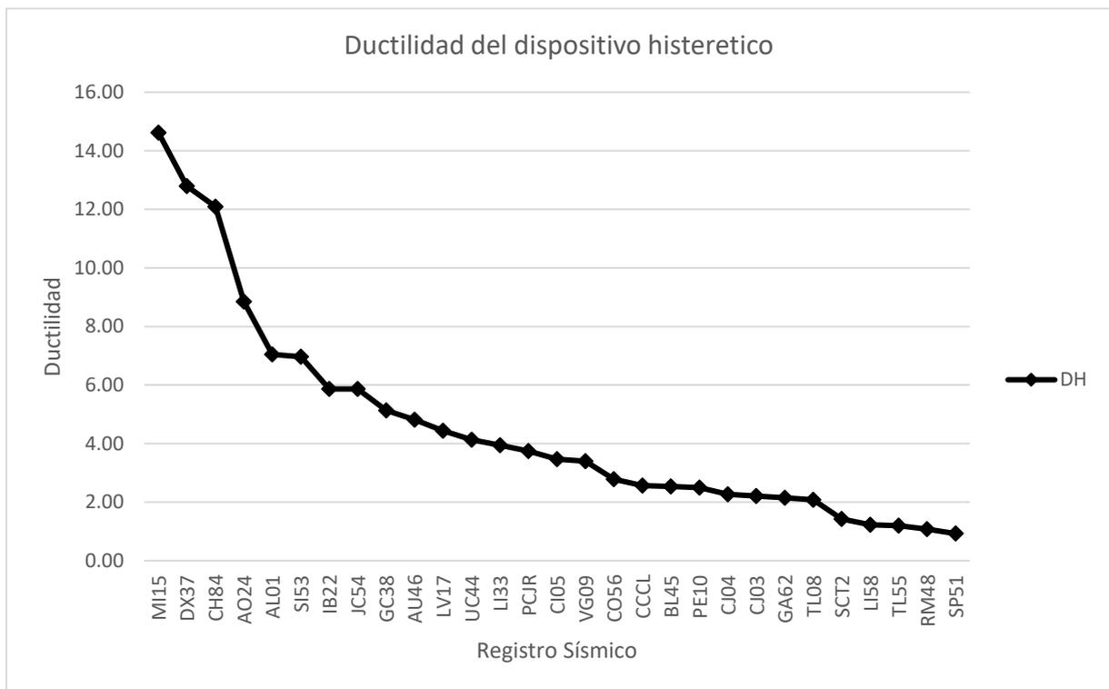
Figura 5.327. Ductilidad del dispositivo disipador de energía TADAS de control del edificio número tres con columnas confinadas en los extremos.
