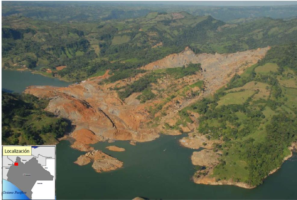
Figura 1.1: Vista aérea de la zona del deslizamiento y del tapón formado sobre el río Grijalva. Imagen tomada de Melo *et al.* (2009)
