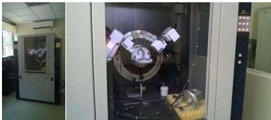
Figura 7. Difractómetro de rayos X D8 ADVNCED
