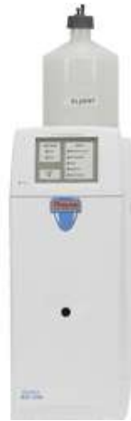
Figura 5. Cromatógrafo de líquidos iónico
