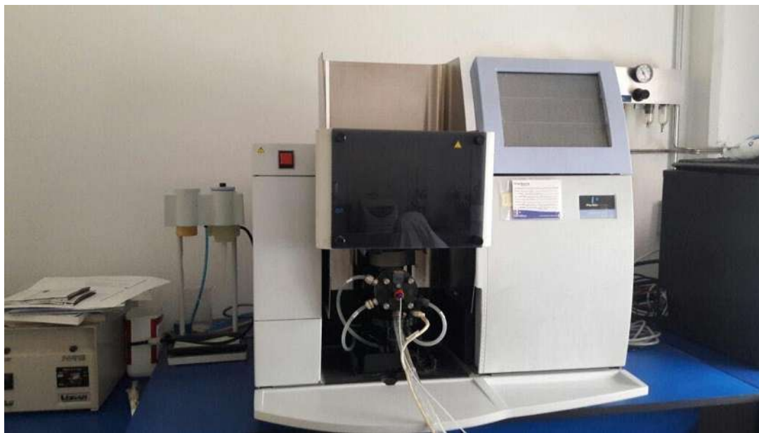
Figura 15. Espectrofotómetro de absorción atómica, utilizado para la lectura de elementos traza en las muestras.
