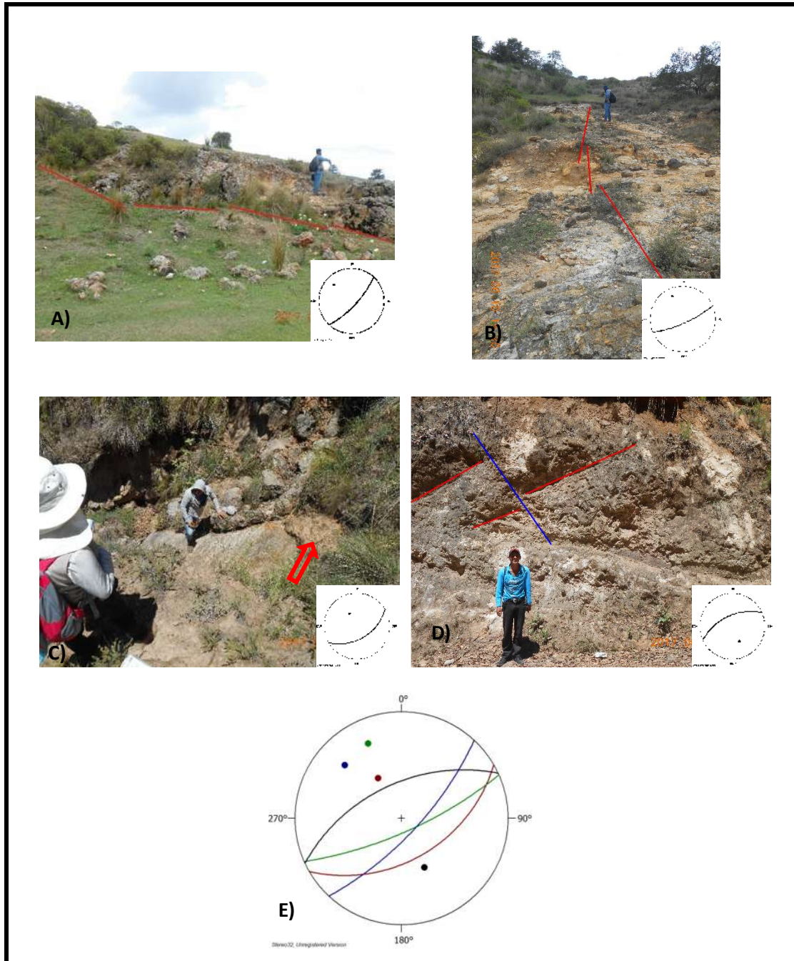
FIGURA 56. Fotografías de afloramiento de las fallas medidas en campo. A) Punto 11. En la zona de falla se encontró pirita diseminada, azufre y goethita. B) Punto 19. Falla normal con presencia de óxidos. C). Punto 43. Falla normal en las dacitas del cerro Terrerillos. D) Punto 76. Zona de alteración argílica sobre la carretera a Matlahuacala, en el sitio se identificaron dos sistemas de fallas. E) Estereograma en el que se representan los planos correspondientes a las 4 fallas encontradas en campo.
