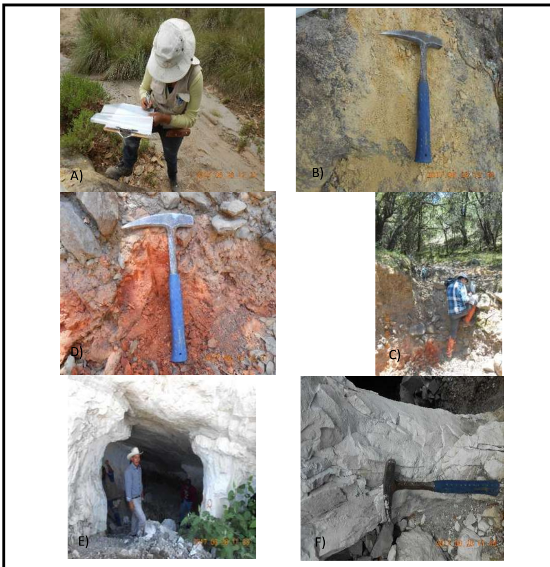
FIGURA 34. Proceso de recolección de muestras: A) y C) Asignación de clave a la muestra, B) Recolección de roca alterada argílicamente, D) Acercamiento al lugar donde se tomó una muestra de oxidación, E) Miembros del equipo de trabajo midiendo el espesor de las capas caolín en el banco de material de Tepeapulco (Hidalgo) y F) Acercamiento al caolín del banc de material.
