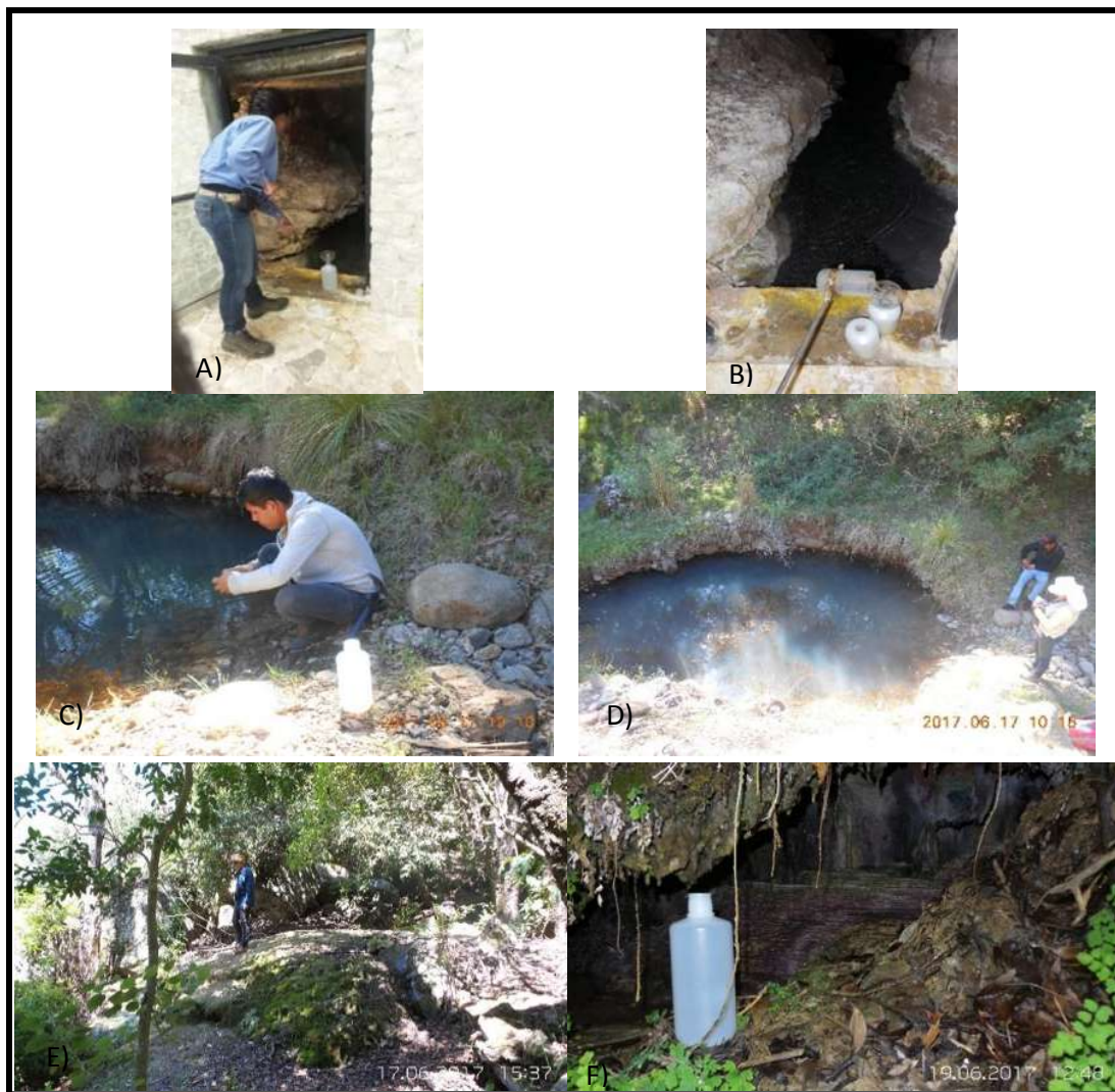
FIGURA 37. Muestro de manantiales. A) y B) Se colectó la muestra de agua en botellas de polietileno en los Baños termales de Chignahuapan, Puebla (54 °C). C) y D) Muestreo de manantial frío ubicado a un costado del río Chignahuapan. E) y F). Muestreo de un manantial tibio (26 °C) en Tulimán, Pue.
