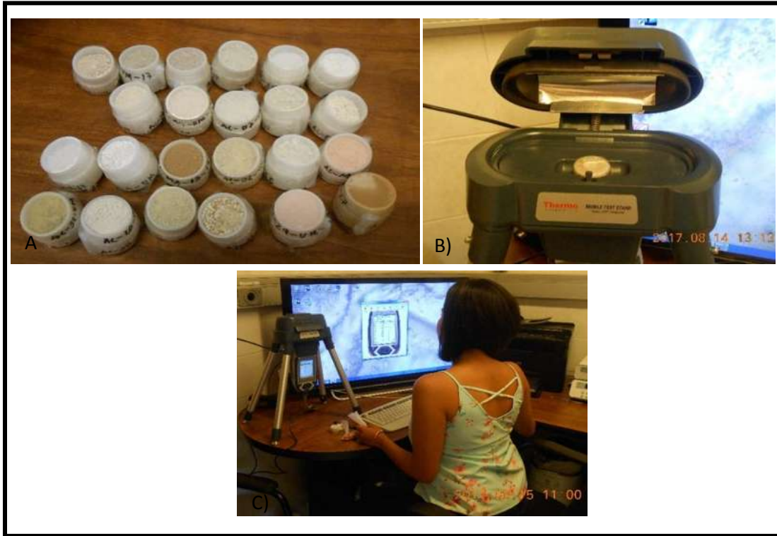
FIGURA 40. Pasos realizados para obtener la Fluorescencia de Rayos X (FRX-ED) empleando la herramienta portátil Niton XL3t GOLDD+. A) Briquetas etiquetadas en la que se vaciaron las muestras molidas, B) Colocación de la muestra en la pistola NITON y C) Selección del tipo de análisis requerido desde el software del equipo.
