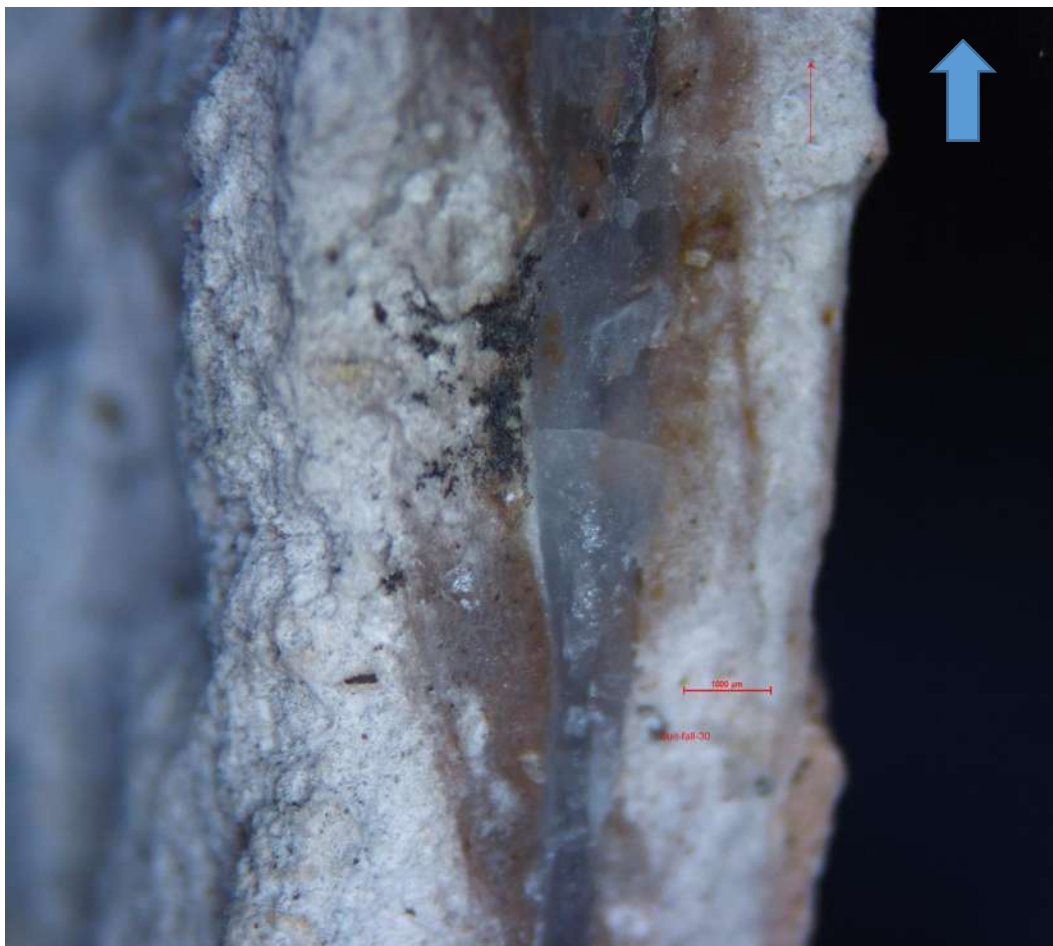
Figura VII.32. Se muestra en la imagen un corte lateral de la muestra Cuit-Fall-30, en el que se evidencian las tres fases de depósitos minerales por los que paso la estructura hasta ser aparentemente sellada por estos minerales neoformados. La flecha indica la cima de la muestra, al momento de ser recolectada en campo.
