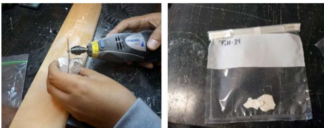
Figura VI.6. En la figura se muestran fotografías del método de limpieza y selección de muestra mediante el corte de la muestra con un disco de corte con polvo de diamante.
