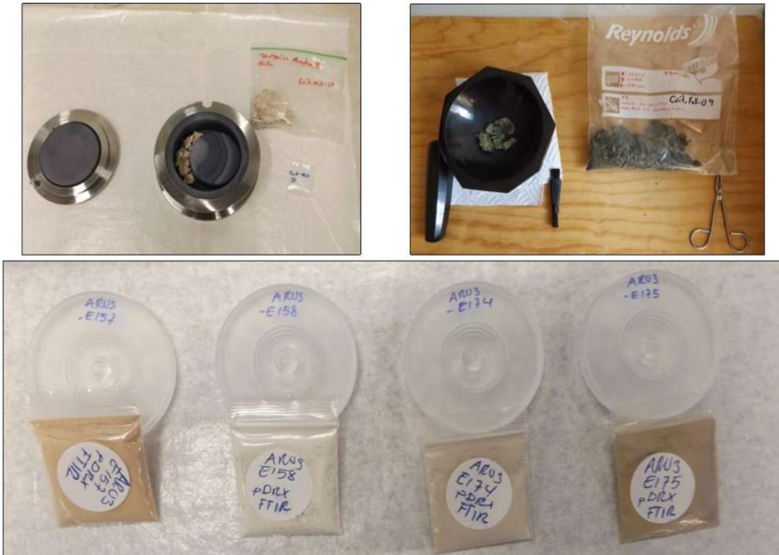
Figura VI.7. En la figura se muestran fotografías del montaje de muestra en el molino mecánico de ágata (superior izquierda), el mortero de ágata para molienda manual (superior derecha) y las muestras ya molidas y listas para el montaje en los portamuestras redondos de vidrio para difractometro.
