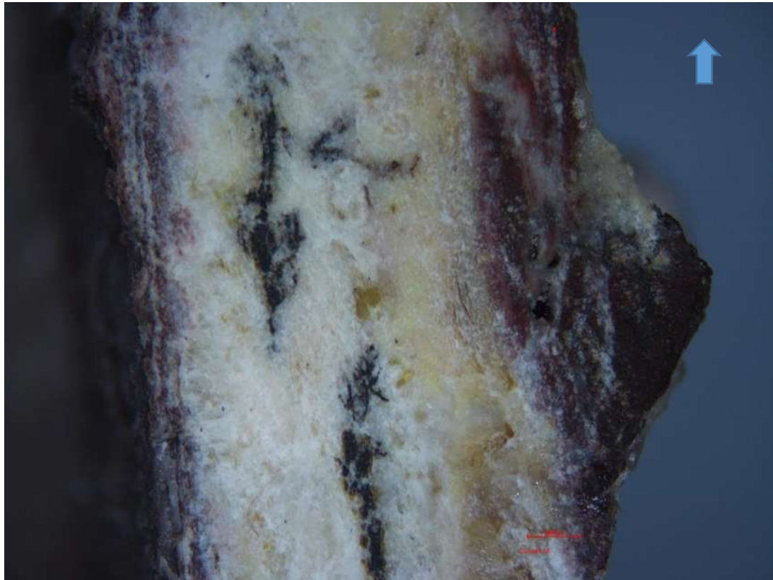
Figura VII.30. Corte lateral de la muestra Cuit-Fall-18, en el cual se aprecia el cambio de la coloración y de textura en el mineral de las partes más externas hacia la parte interna; la flecha indica la dirección de la cima de la muestra.
