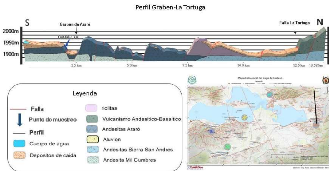
Figura VII.17. Se muestra en la imagen un perfil geológico-estructural con un corte Norte-Sur, en el cual se muestra la distribución de las principales fallas en el Sector Este de la zona de estudio así como la localización de algunos puntos de muestreo en la región.
