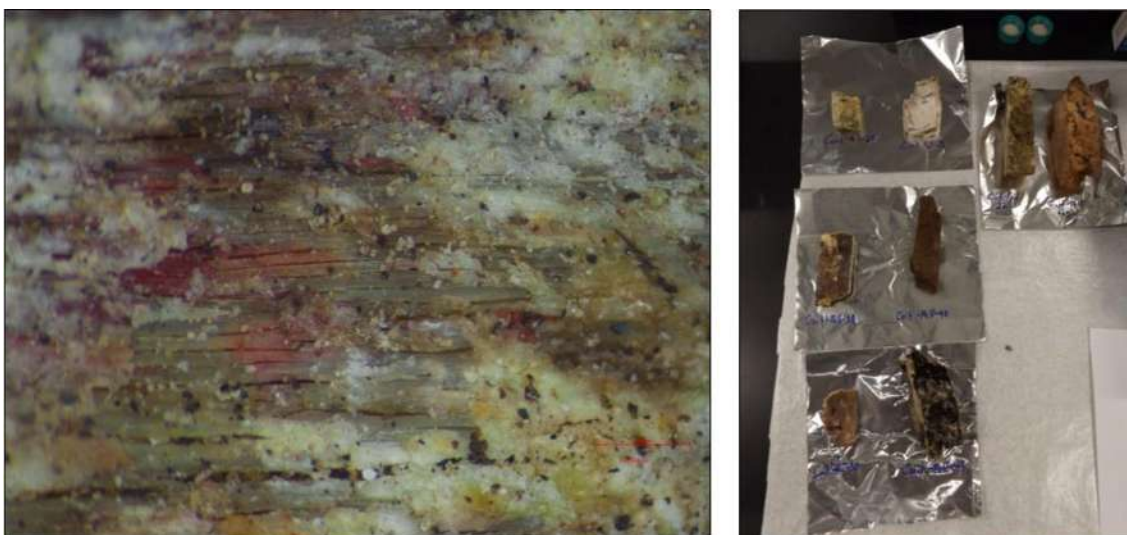
Figura VI.11. En la figura se muestran fotografías de la superficie de una muestra vista con la lupa petrográfica (izquierda) y las muestras ya cortadas y secas, listas para que el técnico pueda llevar a cabo el montaje en los portamuestras para el microtomógrafo.
