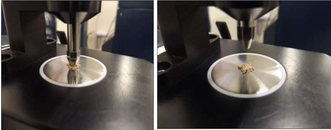
Figura VI.9. En la figura se muestran fotografías del montaje de la muestra y el acomodo en el equipo de análisis de Espectroscopia Infrarroja.
