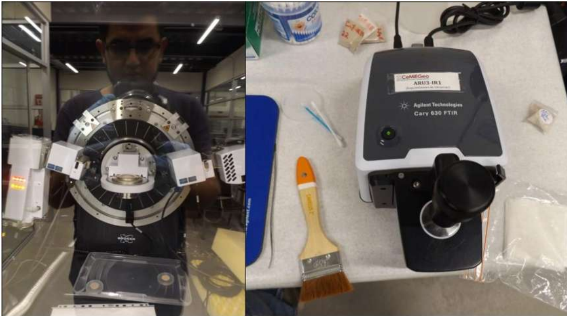
Figura VI.12. En la figura se muestran el equipo Difractómetro de rayos X Bruker D8 Advance (izquierda) y el Espectrómetro de Infrarrojo de la compañía Agilent technologies modelo Cary 630 FTIR (derecha) ambos utilizados durante los análisis de laboratorio, para la determinación de las especies minerales.
