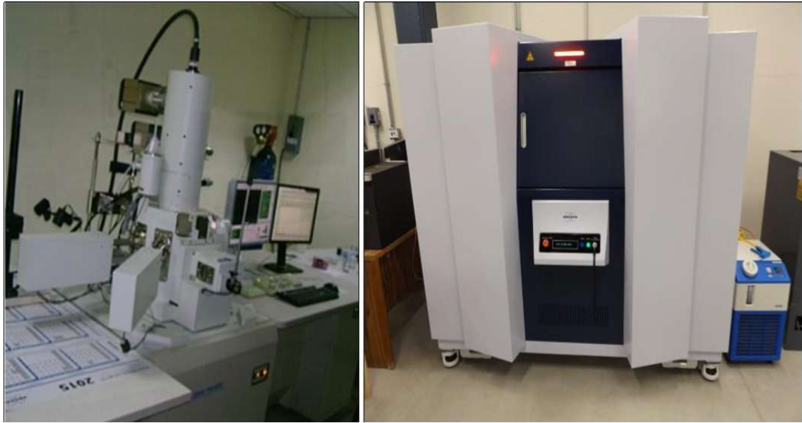
Figura VI.13. En la figura se muestran el equipo microscopio de barrido de emisión de campo JEOL JSM-7600F FEG-SEM (izquierda) y el nanotomografo de rayos X Multiscale Skyscan 2211.
