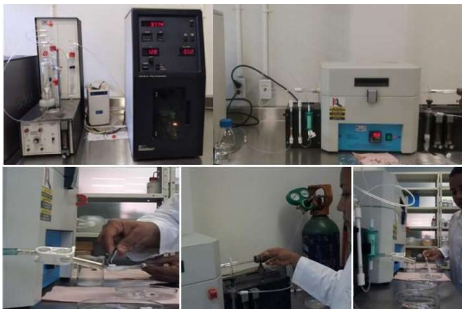
Figura 9. Coulómetro marca UIC, modelo CM5012. Ubicado en el área de Química Analítica y Metabolómica (QUAM) del Instituto de Investigaciones en Ecosistemas y Sustentabilidad.
