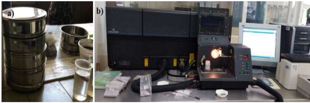
Figura 7. a) Juego de tamices de acero inoxidable. b) Analizador electrónico de micropartículas.
