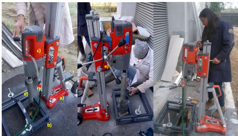
Fig.2.3. Extractor de núcleos Husqvarna® DS 450 conformado por: a) base, b) base de metal para fijar las rocas, c) motor o taladro, d) broca de acero, e) volante y f) manguera de agua.
