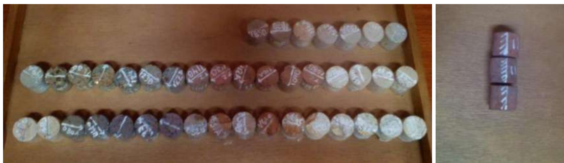
Figura 3.3 a) En la imagen se muestran especímenes de diferentes núcleos, b) núcleo cortado en tres especímenes.
