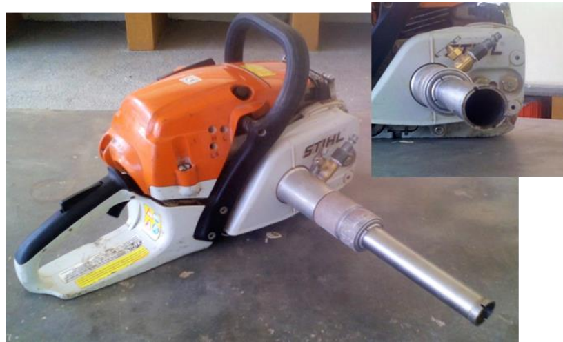
Figura 3.5. a) Perforadora a gasolina y broca hueca.
