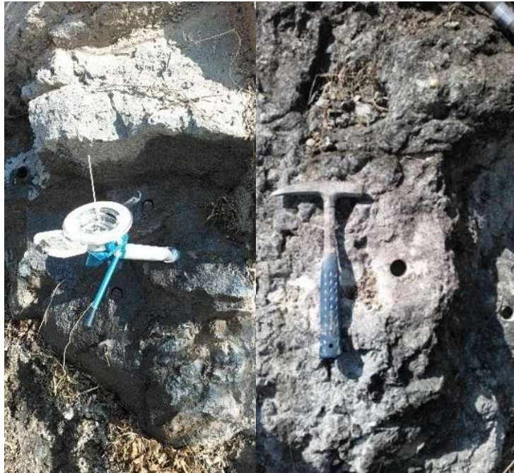
Figura 3.5 A la izquierda se observa la colocación del orientador magnético.
