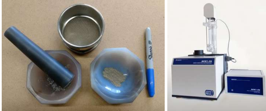
Figura3.7 Susceptibilímetro marca AGICO modelo MFK1 y detalle de la muestra utilizada por sitio para la determinación de la temperatura de Curie
