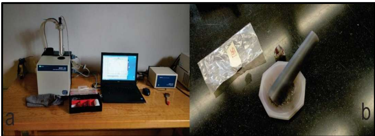
Figura 32: a) Suceptibilímetro marca AGICO modelo MFK1; b) muestra de roca, mortero y martillo.
