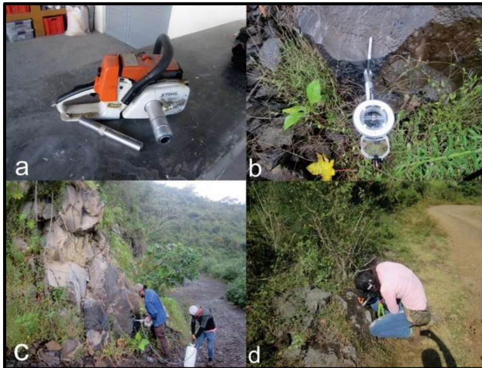
Figura 20: a) Perforadora portátil con gasolina, b) Orientador magnético; c) Extracción de núcleos paleomagnéticos.
