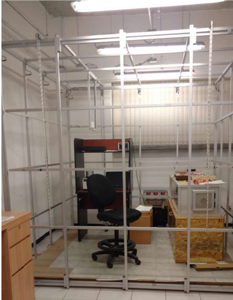
Fig. 21 Equipo de blindaje (Jaula) equipada para aislar el campo magnético, en la parte izquierda se encuentra el desmagnetizador de giro JR6 y en la derecha e horno modelo MMTD80A del Servicio Arqueomagnético Nacional, UNAM unidad Morelia.
