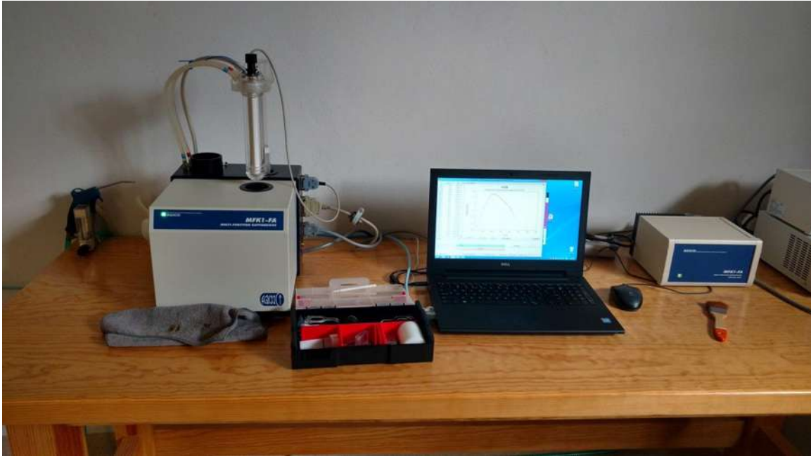
Fig. 20 Kappabridge ó Susceptibilímetro modeo MFK1 utilizado para obtener las curvas termomagnéticas k.T
