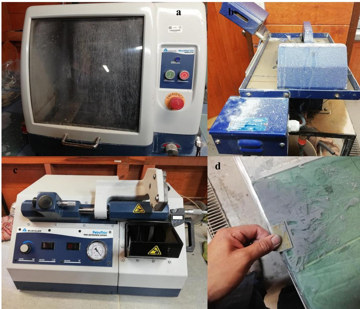
Figura 10. Cortadoras con sus respectivos modelos: a) AbrassiMet 250 de la marca Buehler, b) 10" Buehler Trim Saw + PF 10-10003-160, c) Thin Sectioning System Buehler y d) uso de vidrios con sus respectivos abrasivos (200, 400, 600 y 1000) para pulir la muestra.
