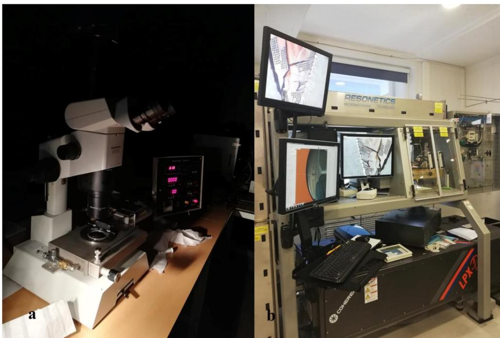
Figura 15. a) Microscopio Binocular SZX 12, b) Espectrómetro de masas (equipo de ablación láser).
