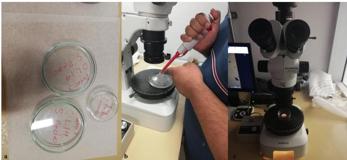
Figura 13. a) Cajas de Petri marcadas con nombre de la muestra, b) y c) Separación de zircones con una pipeta milimétrica.
