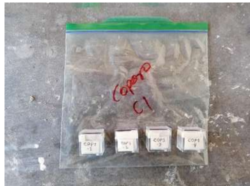
Figura 79. Especímenes de la muestra Cop1 colocados en cubos de plástico.
