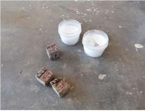
Figura 80. Especímenes sumergidos nuevamente en la solución de pegamento.
