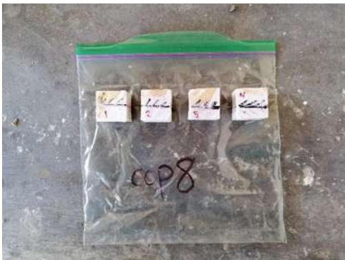
Figura 78. Especímenes obtenidos de la muestra Cop8 encapsulada en yeso.
