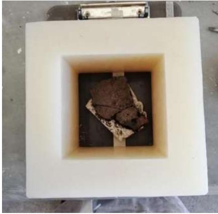
Figura 73. Muestra orientada dentro del cuadro de silicón antes de ser cubierta de yeso.
