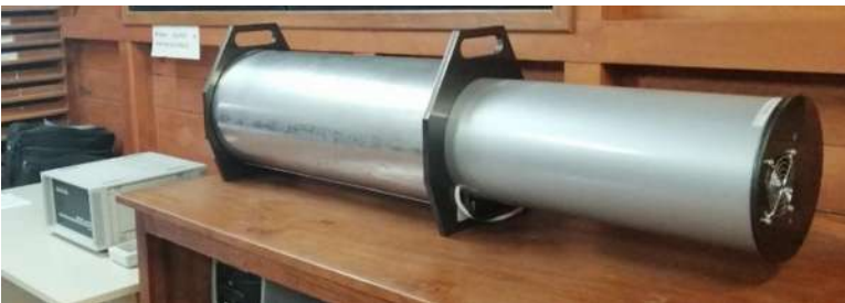
Figura 82. Desmagnetizador LDA 5 marca AGICO.
