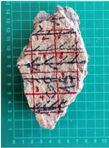
Figura 76. Trazo de las líneas de corte sobre la muestra Cop15.
