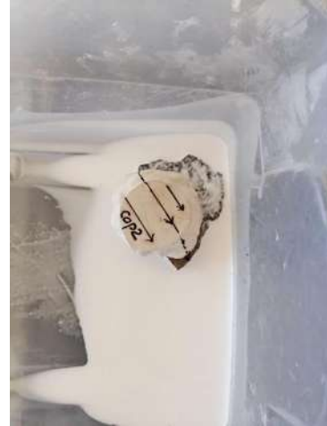
Figura 71. Muestra Cop2 sumergida en la solución de pegamento.
