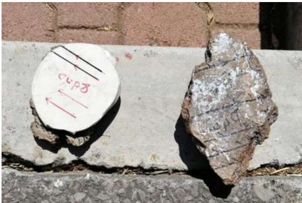
Figura 72. Muestras Cop8 y Cop9 puestas al sol después de ser sumergidas en la solución de pegamento.
