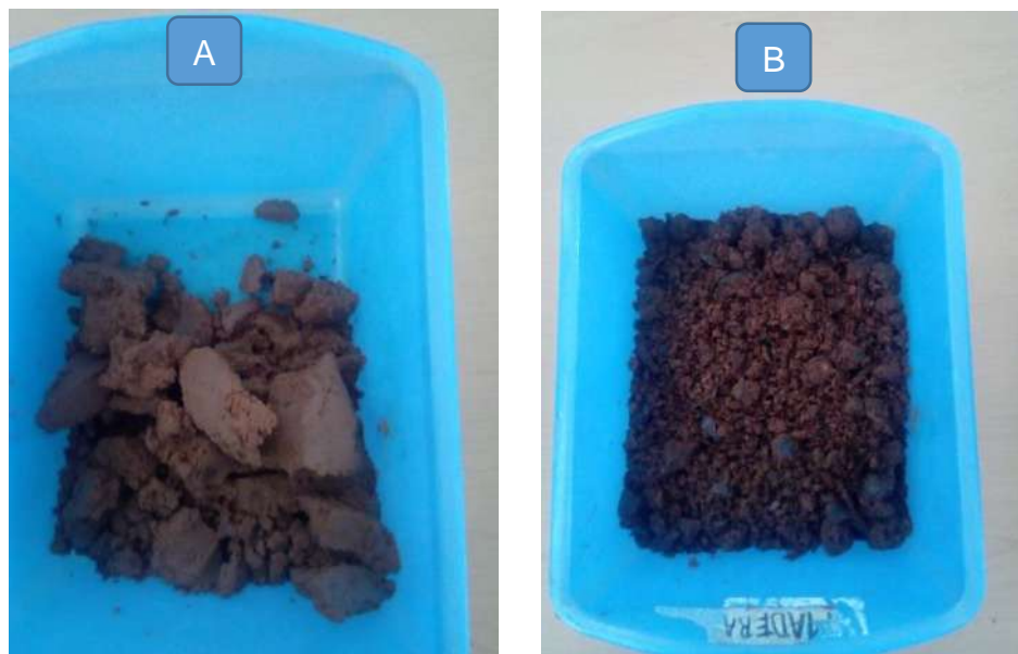
Figura 13 Diferencia de textura en residuos triturados con molino de semillas (B) y con el molino de bolas (A)
