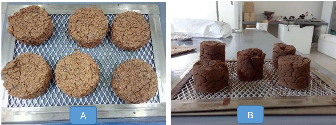
Figura 17 Briquetas elaboradas con la compactadora manual (A) y con la prensa hidráulica (B).
