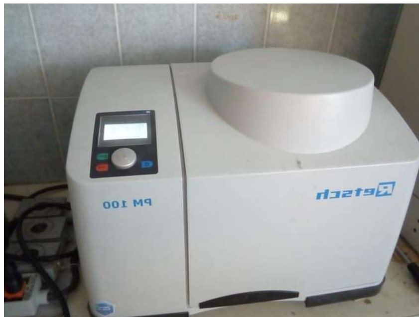
Figura 6 Molino de bolas planetario de la marca Retsch® modelo PM 100
