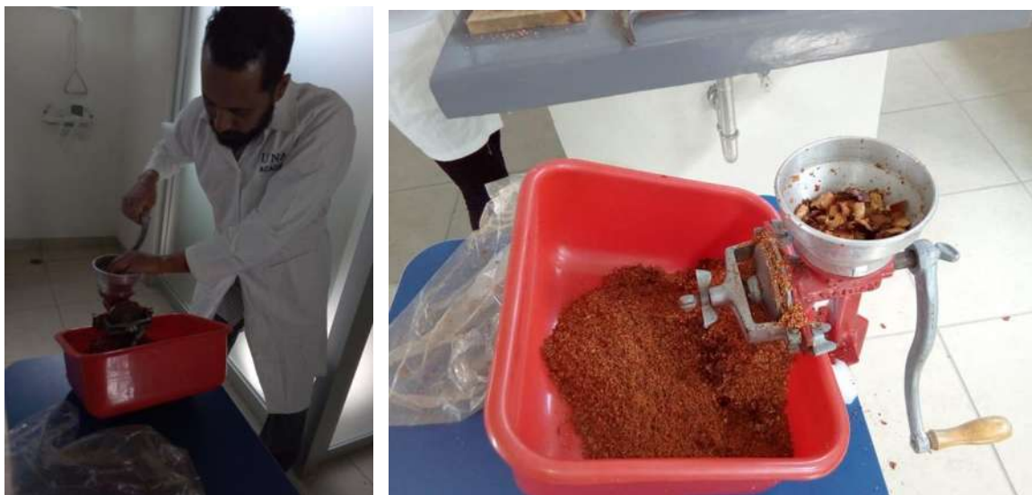
Figura 11 Triturado de residuos de aguacate con molino de semillas tradicional
