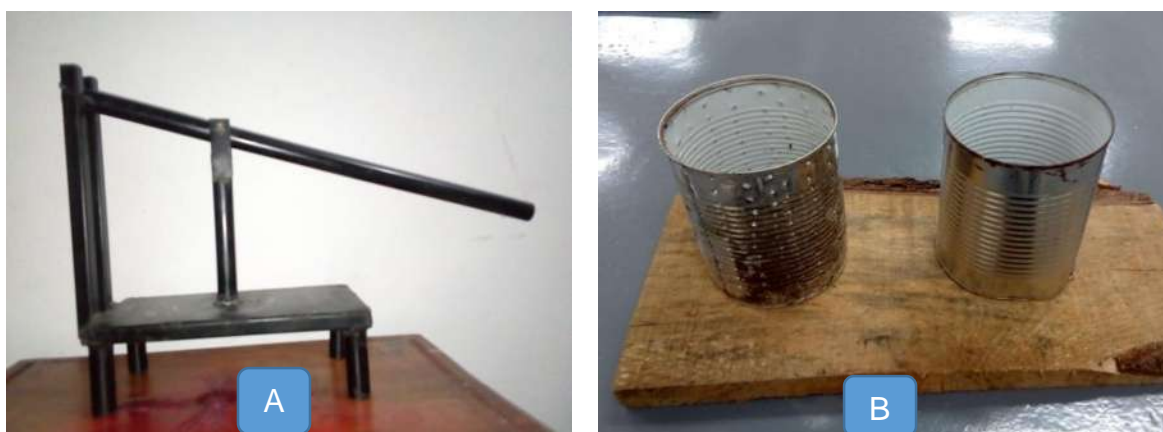
Figura 15 Compactadora manual (A) y moldes utilizados (B) para elaborar las briquetas
