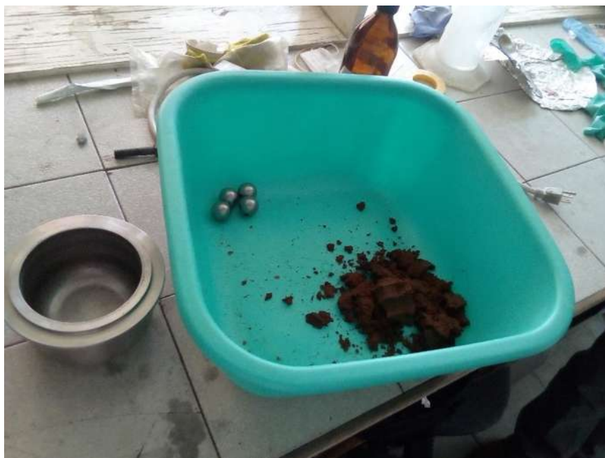
Figura 12 Capsula, bolas de acero del molino de bolas y material triturado
