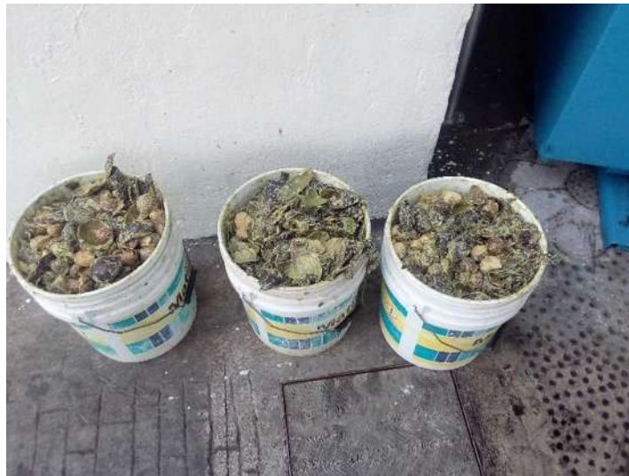
Figura 8 Recipientes con residuo de aguacate utilizados para prueba de peso volumétrico
