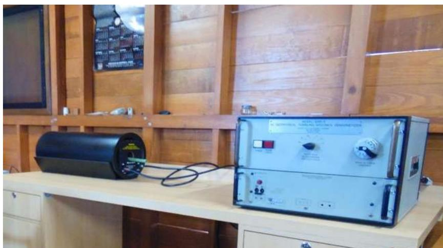
Figura 5.5. Desmagnetizador marca Schonstedt modelo GSD-5.
