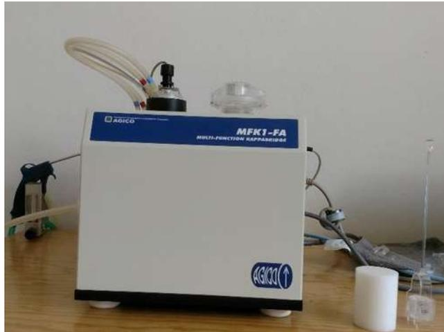
Figura 5.7. Susceptibilímetro marca AGICO modelo MFK1 utilizado para la obtención de curvas termomagnéticas k-T.
