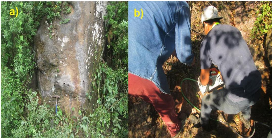
Figura 5.1. a) Afloramiento in situ. b) Extracción de núcleos paleomagnéticos utilizando la perforadora de gasolina.
