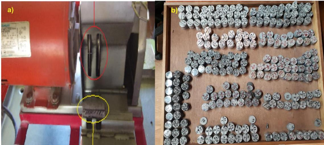
Figura 5.3. a) Cortadora de roca. b) Especímenes obtenidos y marcados.
