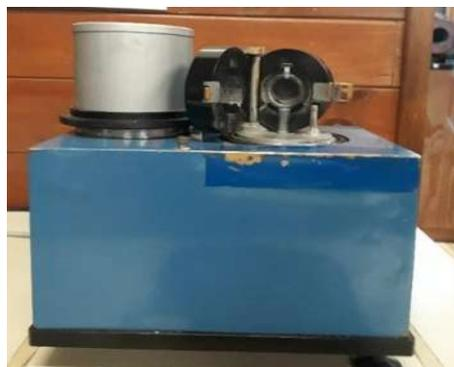
Figura 5.4. Magnetómetro de giro AGICO JR-5.
