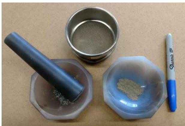
Figura 5.6. Pulverización de la muestra. Los pequeños trozos de la muestra se pulverizaron con un mortero y finalmente se tamizaron para la obtención de un tamaño uniforme.
