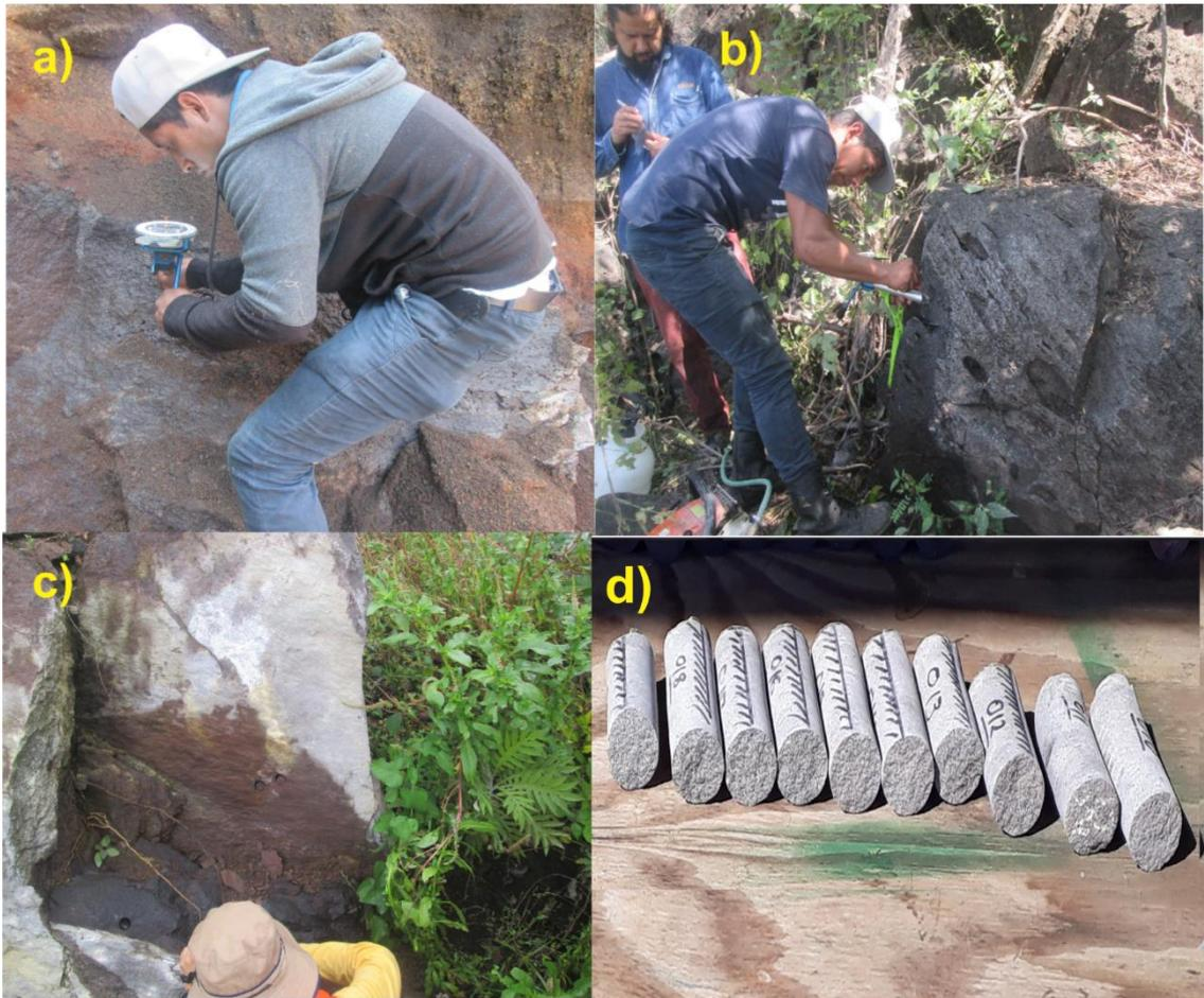
Figura 5.2. a) Orientación del núcleo. b) Marcación del núcleo. c) Extracción. d) Núcleos paleomagnéticos.
