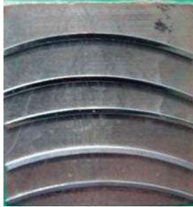
Figura VII.4. Base metálica usada para el montaje de alambres Ni-Ti.
