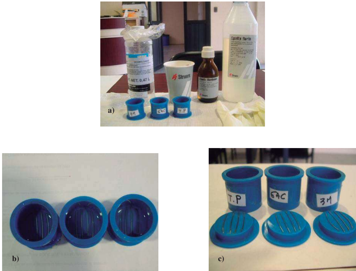
Figura VII.3. Preparación de muestras por método de encapsulamiento en frío, a) resina, endurecedor y líquido desmoldante; b) moldes y c) probetas con alambres Ni-Ti.
