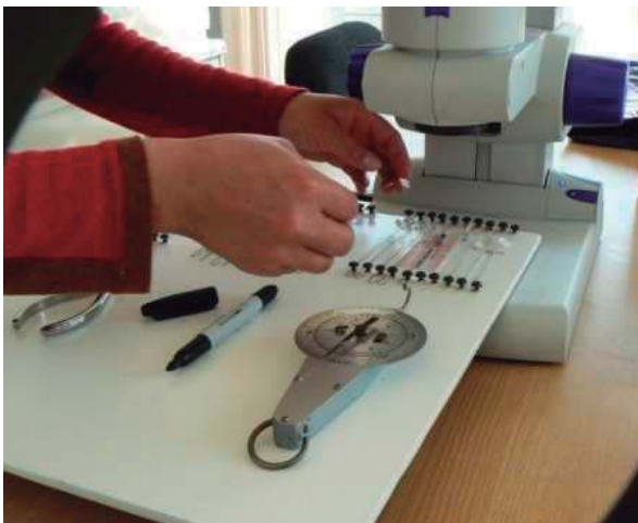
Figura 1. Imagen de las pruebas realizadas en cada una de las 30 barras de 0.016"X0.022" con doblez de bull loop, de las cuales, 10 fueron de acero inoxidable, 10 de beta-titanio y 10 de cromo-cobalto.
