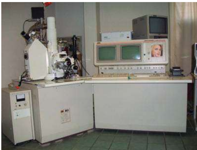
Fig. 16 Microscopio Electrónico de barrido marca Jeol. Modelo: JSM-6400 y Microanalizador marca Broker modelo: X-flash 4010. (Instituto de investigaciones metalúrgicas de la U.M.S.N.H).
