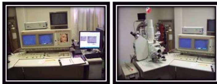
Figura 19. Microscopio electrónico de barrido donde se observaron las muestras a 15x, 100x y 200x.
