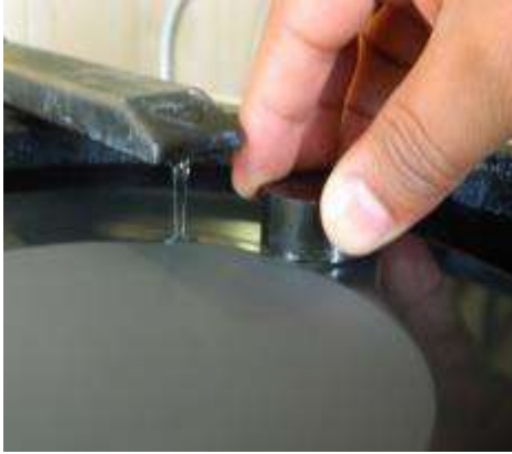
Fig. 15. Muestra en proceso de desbastado.
