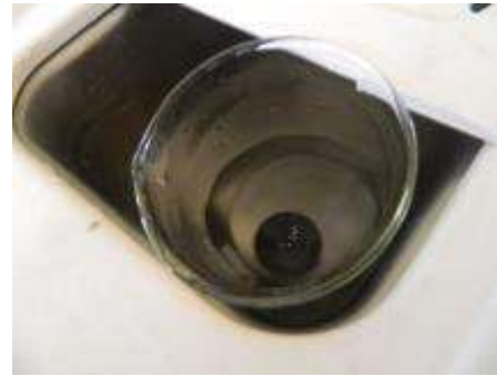
Fig. 18. Proceso de limpieza por ultrasonido.
