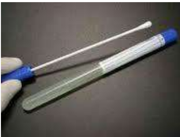
Figura 7. Hisopo usado para la toma de muestras de las distintas superficies a analizar.
