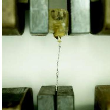
Fig. 15. Non Eugenol Temporary Cement Prime Dent muestra 03 desprendimiento del dispositivo con extrusión del material.
