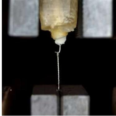
Fig. 17 Ionomax muestra 03 deformación del hélix, extrusión del bloque de cemento durante el deslizamiento del dispositivo intraconducto hasta el momento del desprendimiento.
