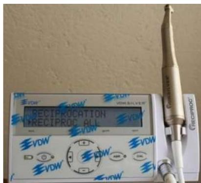
**Figura #4** Motor Silver Reciproc VDW para la utilización de las limas R25 Y Wave-One Primary (Fotografía tomada por el autor de la presente tesis).
