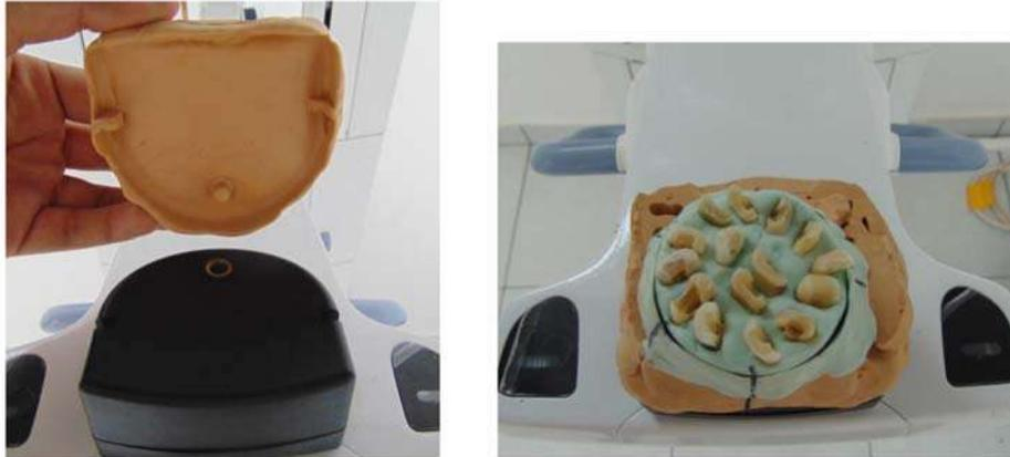
**Figura 15:** Muestras montadas en plantilla de silicón listas para obtener imagen tomográfica.
