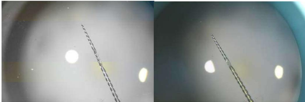
**Imagen 21:** Imagen obtenida del microscopio dental, donde se observan dos limas deformadas.
