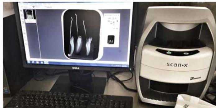
**Figura 13:** Muestras en silicón por adición montadas en dispositivo prefabricado y escáner radiográfico ScanX Duo, Air Techniques.
