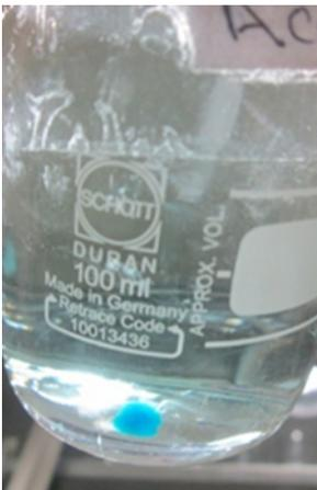
Fig. 19, disco en acetona donde se apreció ligera decoloración que evidenció el adhesivo resinoso coloreado.
