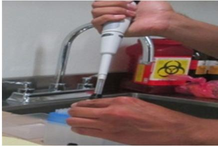
Fig. 1, fotografía de micropipeta, donde se muestra el procedimiento de cuantificación del adhesivo.
