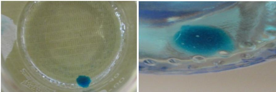
Figuras 31 y 32, disco colocado en ácido acético glacial, donde solo se observó cambio decoloración en la circunferencia del disco, como un halo perimetral.
