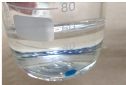
Figuras 27 y 28, disco en solvente para poliuretanos, donde se observa que no existieron cambios en la coloración, solo en la consistencia, haciendo a este flexible.
