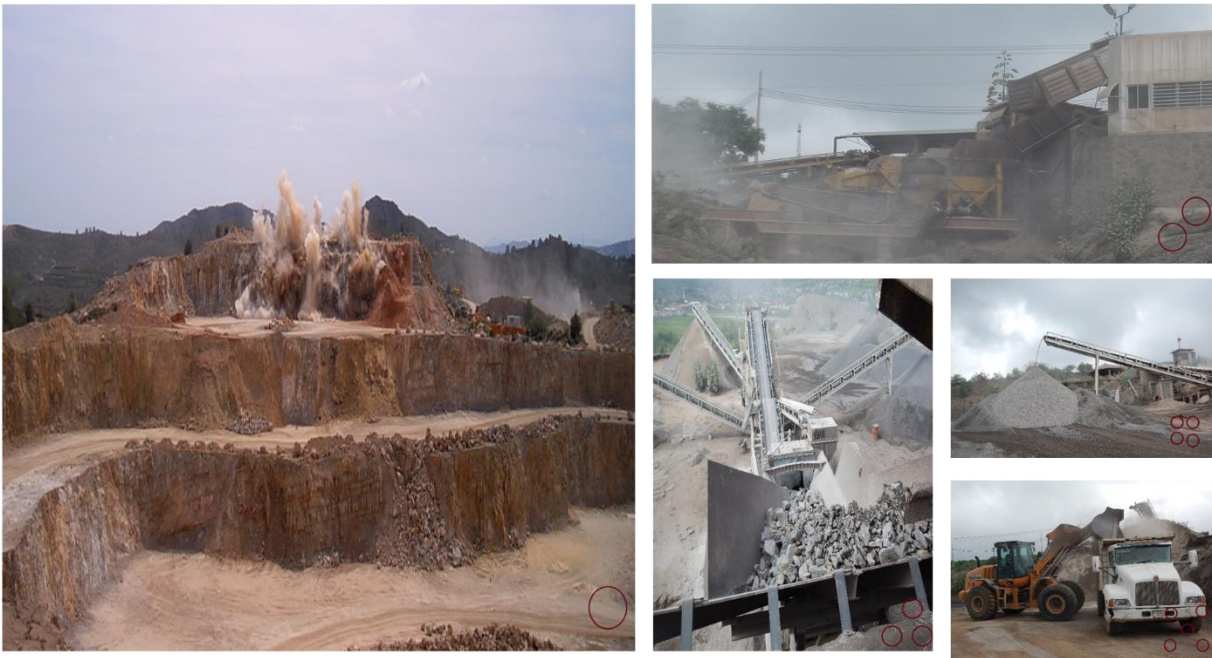
Figura 10.- Proceso de producción de agregado grueso natural (AN).
