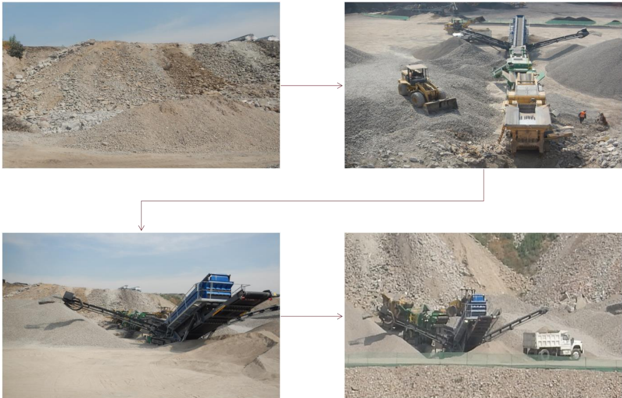
Figura 11.- Proceso de producción de agregado grueso reciclado (AR).
