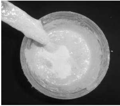
Figura 28. Producto de disolución de Monómero de Estireno/EPS adición de nanosílice y marmolina.
