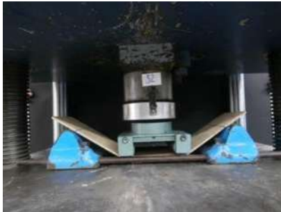
Figura 40. Probetas del bloque D sujetas a flexión estática. La figura izquierda corresponde a una probeta de dos placas de dimensiones 15 x 60 x 0.51 cm. La figura derecha corresponde a una probeta a cuatro placas de dimensiones 15 x 60 x 1.1 cm.
