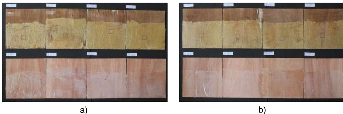
Figura 13. Películas del producto de la disolución de Gasolina Magna PEMEX/EPS adición de nanosílice sobre sustratos de triplay de pino. Por ciento máximo (a) y por ciento óptimo (b).
