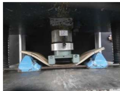
Figura 38. Probetas del bloque B sujetas a flexión estática. La figura izquierda corresponde a una probeta a dos placas de dimensiones 15 x 60 x 0.51 cm. La figura derecha corresponde a una probeta a cuatro placas de dimensiones 15 x 60 x 1.1 cm.
