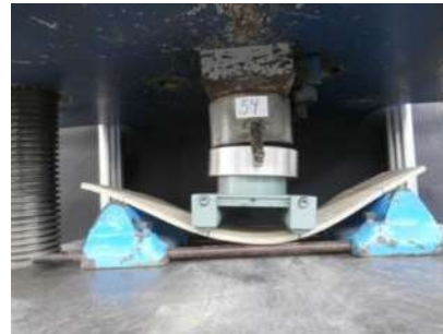
Figura 41. Probetas del bloque E sujetas a flexión estática. La figura izquierda corresponde a una probeta dos placas de dimensiones 15 x 60 x 0.5 cm. La figura derecha corresponde a una probeta a tres placas de dimensiones 15 x 60 x 0.75 cm.
