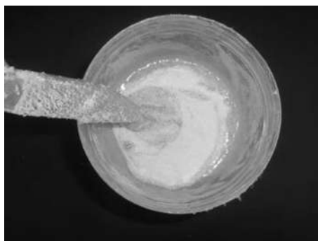
Figura 32. Producto de disolución de EPS/Tolueno adición de cargas de nanosílice y marmolina.
