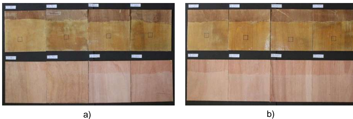
Figura 19. Películas del producto de la disolución de Monómero de Estireno/EPS adición de nanosílice sobre sustratos de triplay de pino. Por ciento máximo (a) y por ciento óptimo (b).
