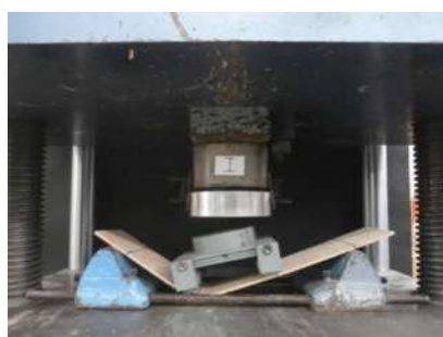
Figura 37. Probetas del bloque A sujetas a flexión estática. La figura izquierda corresponde a una probeta de dimensiones 15 x 60 x 0.6 cm la figura derecha corresponde a una probeta de dimensiones 15 x 60 x 1.2 cm.
