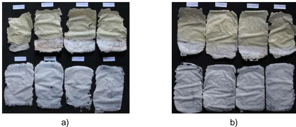
Figura 35. Películas del producto de la disolución de Tolueno/EPS adición de nanosílice y marmolina sobre sustratos de polietileno. Porcentaje máximo (a) y porcentaje óptimo (b).
