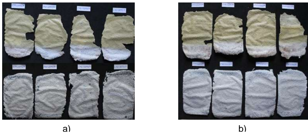
Figura 31. Películas del producto de la disolución de Monómero de Estireno/EPS adición de nanosílice y marmolina sobre sustratos de polietileno. Por ciento máximo (a) y por ciento óptimo (b).
