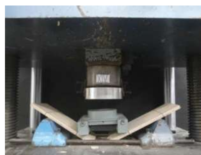
Figura 37. Probetas del bloque A sujetas a flexión estática. La figura izquierda corresponde a una probeta de dimensiones 15 x 60 x 0.6 cm la figura derecha corresponde a una probeta de dimensiones 15 x 60 x 1.2 cm.
