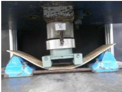
Figura 41. Probetas del bloque E sujetas a flexión estática. La figura izquierda corresponde a una probeta dos placas de dimensiones 15 x 60 x 0.5 cm. La figura derecha corresponde a una probeta a tres placas de dimensiones 15 x 60 x 0.75 cm.
