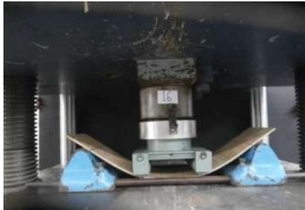
Figura 39. Probetas del bloque C sujetas a flexión estática. La figura izquierda corresponde a una probeta dos placas de dimensiones 15 x 60 x 0.48 cm. La figura derecha corresponde a una probeta a cuatro placas de dimensiones 15 x 60 x 0.98 cm.
