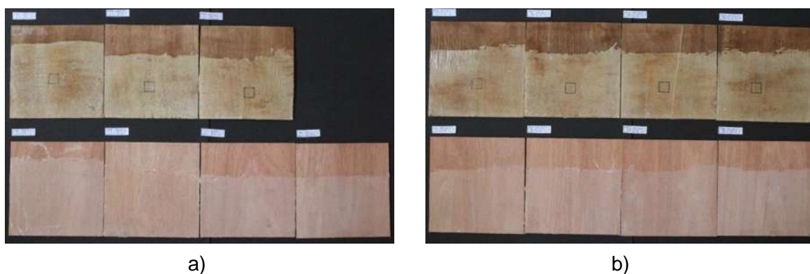
Figura 25. Películas del producto de la disolución de Tolueno /EPS adición de nanosílice sobre sustratos de triplay de pino. Porcentaje máximo (a) y porcentaje óptimo (b).
