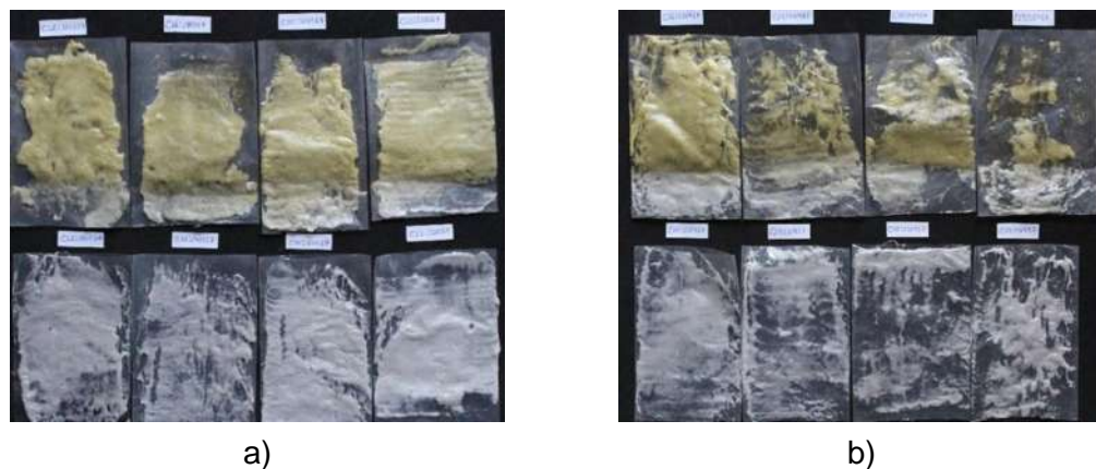
Figura 15. Películas del producto de la disolución de Gasolina Magna PEMEX/EPS adición de nanosílice sobre sustratos de polietileno. Por ciento máximo (a) y por ciento óptimo (b).
