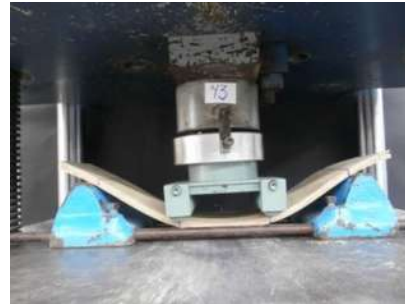
Figura 40. Probetas del bloque D sujetas a flexión estática. La figura izquierda corresponde a una probeta de dos placas de dimensiones 15 x 60 x 0.51 cm. La figura derecha corresponde a una probeta a cuatro placas de dimensiones 15 x 60 x 1.1 cm.
