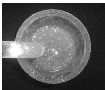
Figura 22. Producto de la disolución de Tolueno/EPS.
