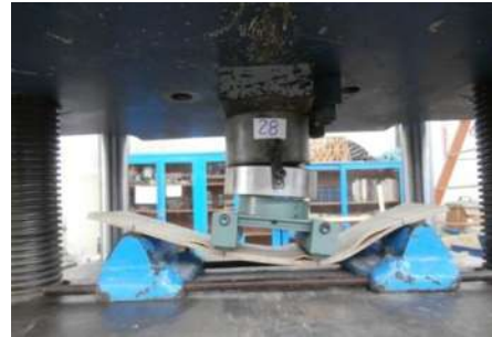
Figura 39. Probetas del bloque C sujetas a flexión estática. La figura izquierda corresponde a una probeta dos placas de dimensiones 15 x 60 x 0.48 cm. La figura derecha corresponde a una probeta a cuatro placas de dimensiones 15 x 60 x 0.98 cm.
