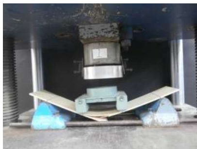
Figura 38. Probetas del bloque B sujetas a flexión estática. La figura izquierda corresponde a una probeta a dos placas de dimensiones 15 x 60 x 0.51 cm. La figura derecha corresponde a una probeta a cuatro placas de dimensiones 15 x 60 x 1.1 cm.
