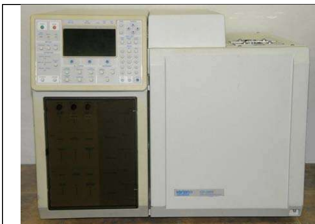
Figura 3.5. Cromatógrafo de gases VARIAN CP5800
