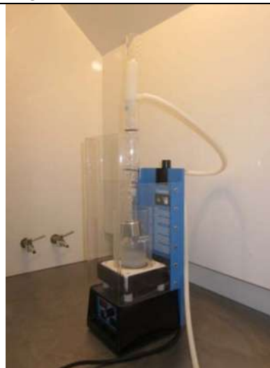
Figura 3.4. Reactor de digestión empleado en la determinación de N_{TK}
