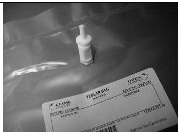
Figura 3.6. Bolsas tedlar empleadas para muestreo y almacenamiento de biogás.
