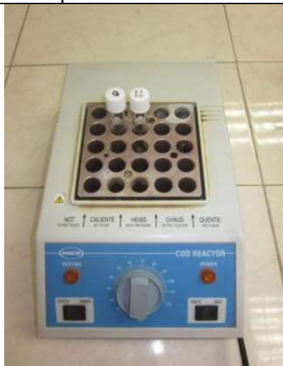
Figura 3.3. Reactor HACH de DQO empleado en la determinación de DQO y P_T .
