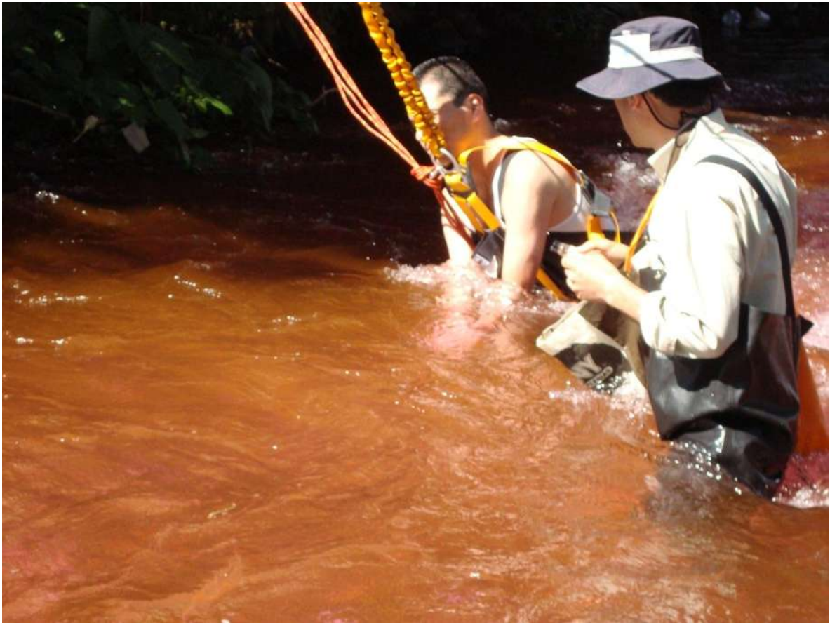
Figura 24. Paso de la nube de trazadores por el Sitio 2, experimentación 1
