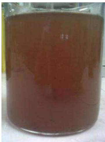
Figura 11. Agua de salida del reactor UASB a 35°C
