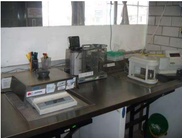
**Ilustración 43** Se muestra el cuarto de gravimetría con las básculas y los equipos de ambientación
