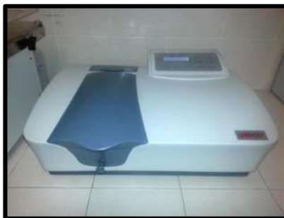
Figura 13. Espectrofotómetro UV-Visible
